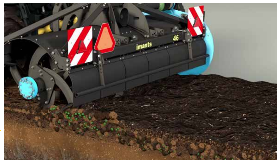
Zpracování půdy rýčovým kypřičem Rýčový segment na hřideli - detail
