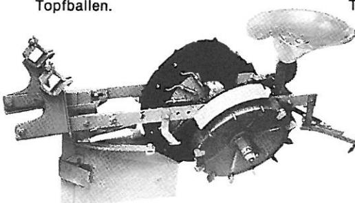
Plantehjulene er alle af samme diameter og monterbare på type M. De er forsynet med forskelligt antal gribere hvis indbyrdes afstand er bestemende for planteafstanden.
